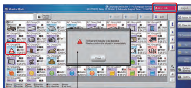
Wyskakujące okienko z informacją o wycieku
