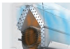
Wymiennik typu "lambda" *3
