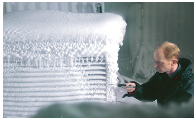
Komory klimatyczne symulują wszystkie potencjalne warunki eksploatacji
